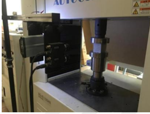
Fotoğraf 133. Elastisite modülünün video ekstansometre ile belirlenmesi
