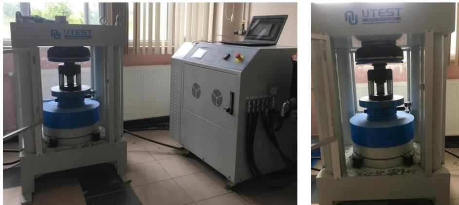
Fotoğraf 3.10. Basınç dayanımı test cihazı ve basınç dayanımının belirlenmesi
