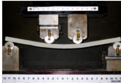
Şekil 2.2. ECC'nin eğilme yüküne karşı davranışı (Weimann ve Li, 2003a)
