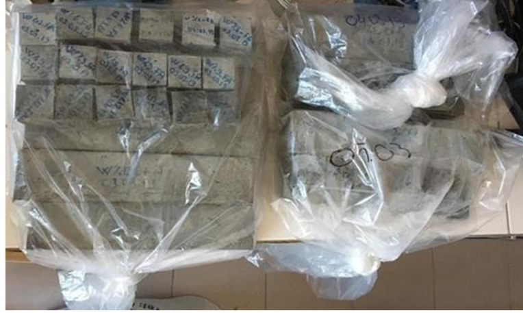
Fotoğraf 3.9. Üretimden sonra ECC numunelerinin kür edilmesi
