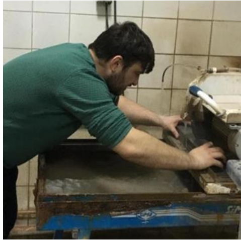
Fotoğraf 3.11. Matris tokluğu için numuneye çentik açılması
