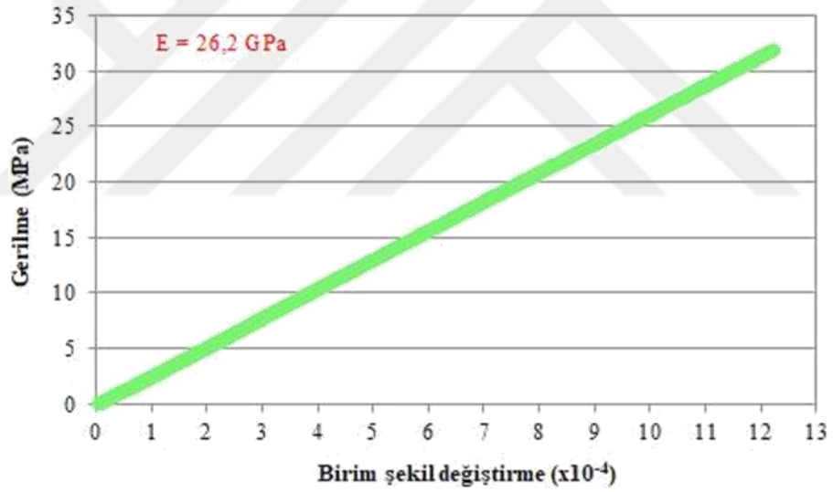
Şekil 3.5. Elastisite modülünün belirlenmesine ait tipik bir gerilme-birim şekil değiştirme diyagramı
