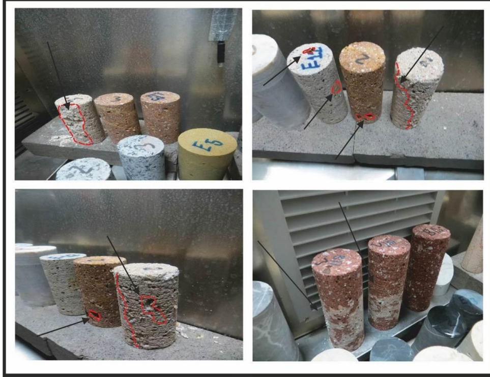
Şekil 3.40. Don kaybı deneyi sırasında karot örneklerinde gözlenen bozunma etkileri
