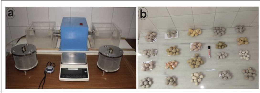
Şekil 4.39. a) Suda dağılmaya karşı duraylılık indeksi deney aletinin aparatları, b) deney için hazırlanan örneklerden bir görünüm
