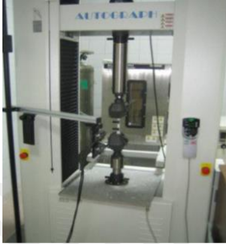
Fotoğraf 2.3. Shimadzu Autograph 100 kN çekme deney cihazı
