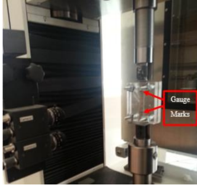
Fotoğraf 2.2. Çekme-basma deneyi yardımcı aparat bağlantısı
