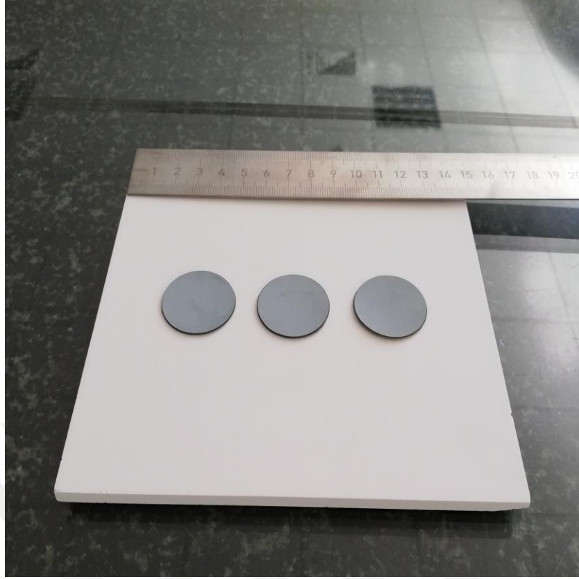
Fotoğraf 3.5. Sinterlenmeden önce anot destekli membran
