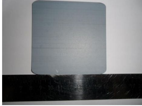
Fotoğraf 4.7 Laminasyon işlemi sonrası preslenmiş anot destekli elektrolit
