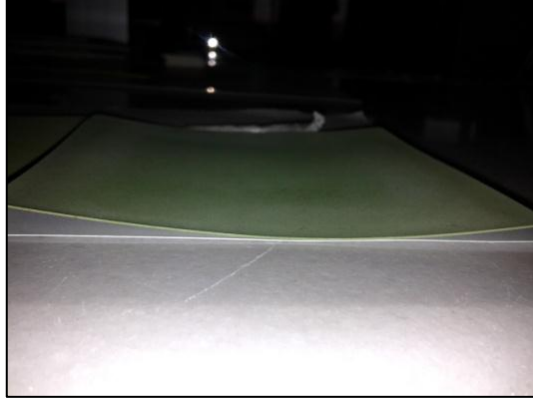
Fotoğraf 5.1 Birlikte sinterleme işlemi sonrası oluşturulmuş 100 cm 2 alana sahip anot destekli elektrolit
