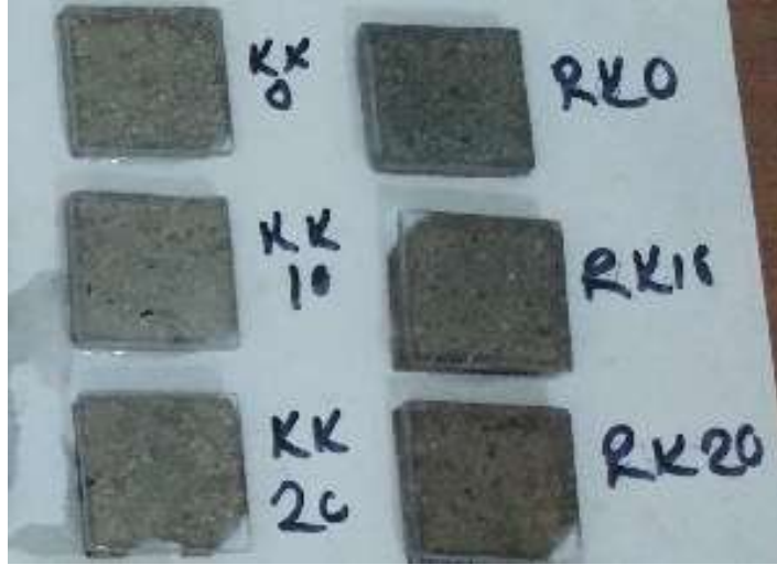
Fotoğraf 3.10. Daitomitli harçların PLM analizi için hazırlanan ince kesit örnekleri
