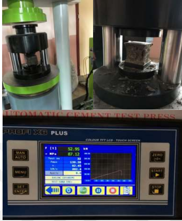
Fotoğraf 3.8. Basınç deneyinin yapılışı
