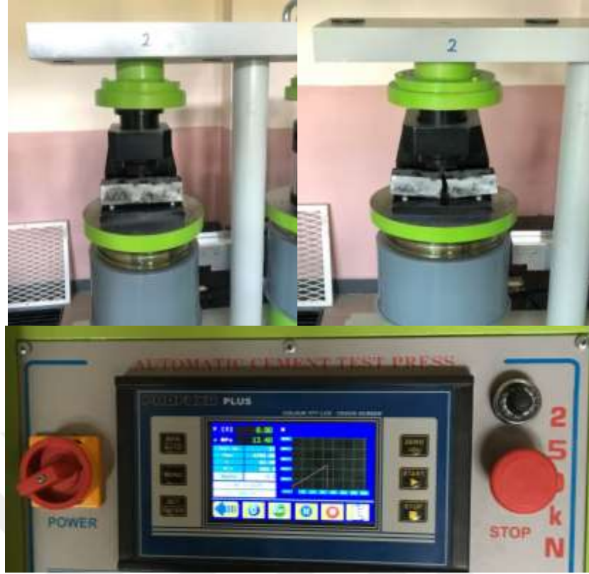
Fotoğraf 3.7. Eğilme deneyinin yapılışı
