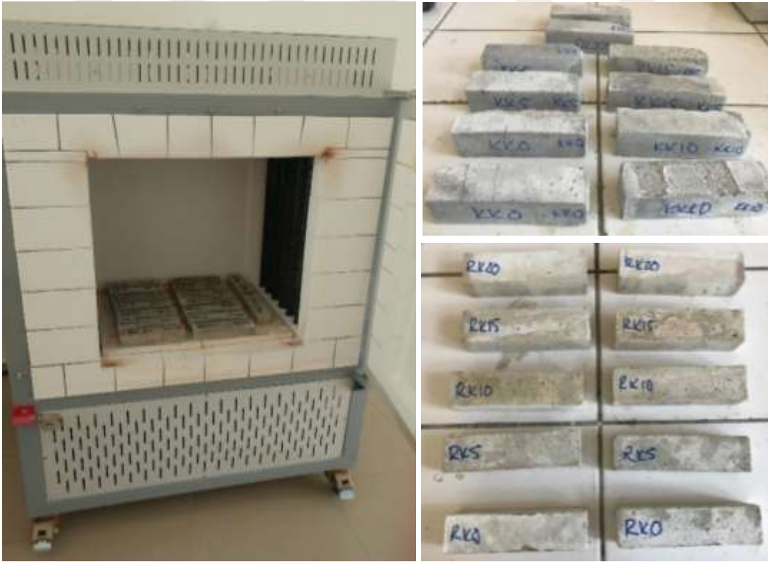
Fotoğraf 3.3. Yüksek sıcaklıklara maruz kalan numune örnekleri
