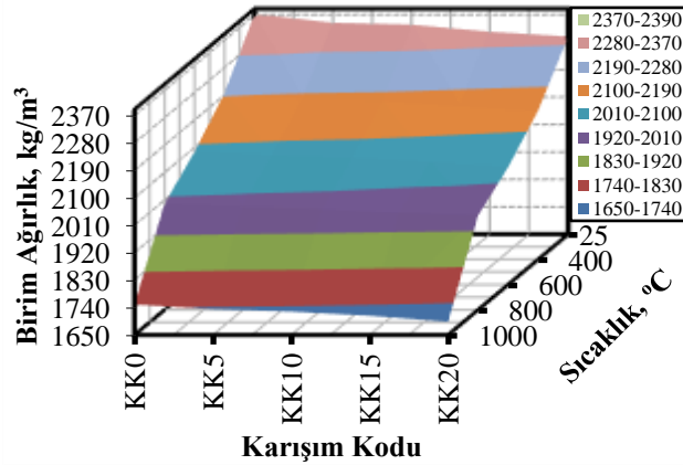
Őekil 4.12. Yksek sıcaklıklara maruz kalan kalker kumu ile retilen diatomitli harların birim ağırlık deęerlerinin u boyutlu deęiřimi
