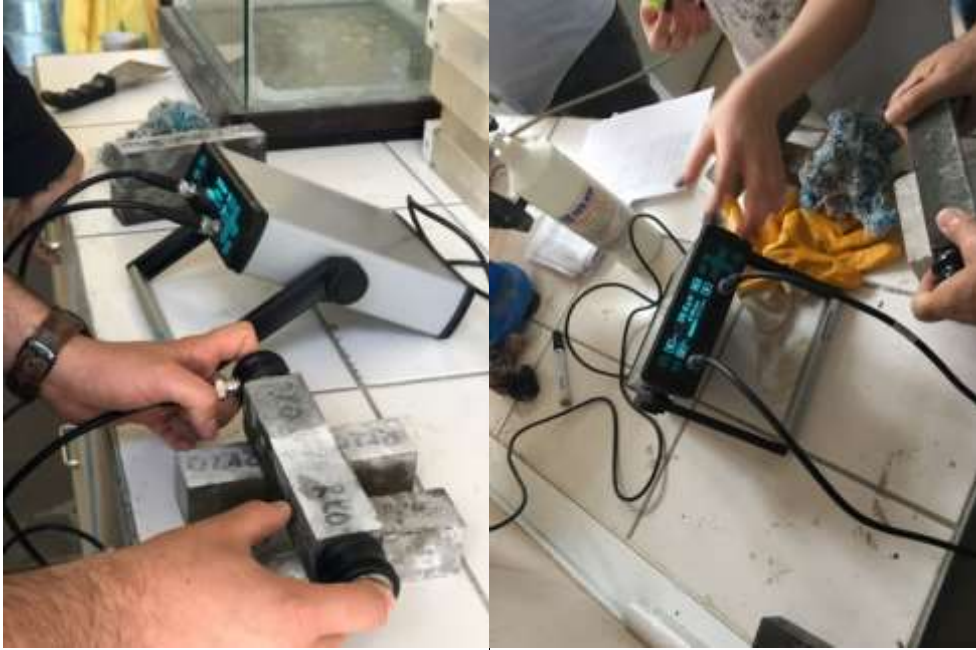
Fotoğraf 3.6. Ultrases geçiş hızı ölçümü
