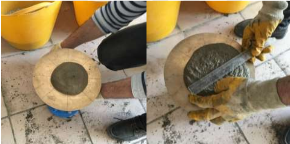
Fotoğraf 3.4. Yayılma deneyi
