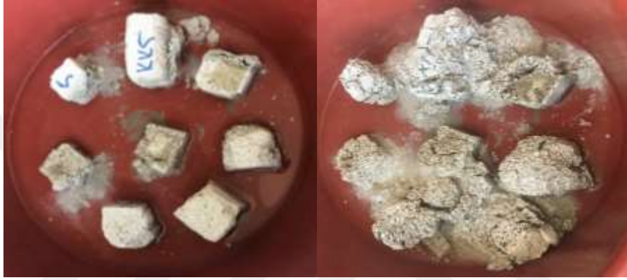
Fotoğraf 4.1. 800 °C ve 1000 °C yüksek sıcaklıklara maruz kalan kalker kumu ile üretilen harçların su ile reaksiyonu
