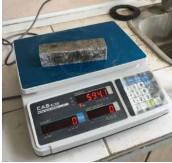
Fotoğraf 3.5. Sertleşmiş birim ağırlık ölçümü
