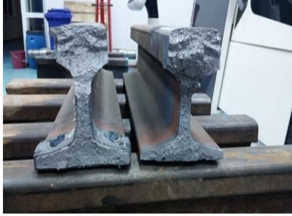
Fotoğraf 4.2. Z 1 numunesinin eğme testi sonrası görüntüsü
