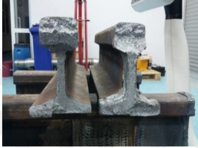
Fotoğraf 4.4. Z_3 numunesinin eğme testi sonrası görüntüsü
