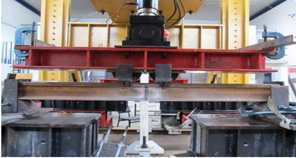
Fotoğraf 3.1. Rayın yorulma deney düzeneği (Onay, 2004)
