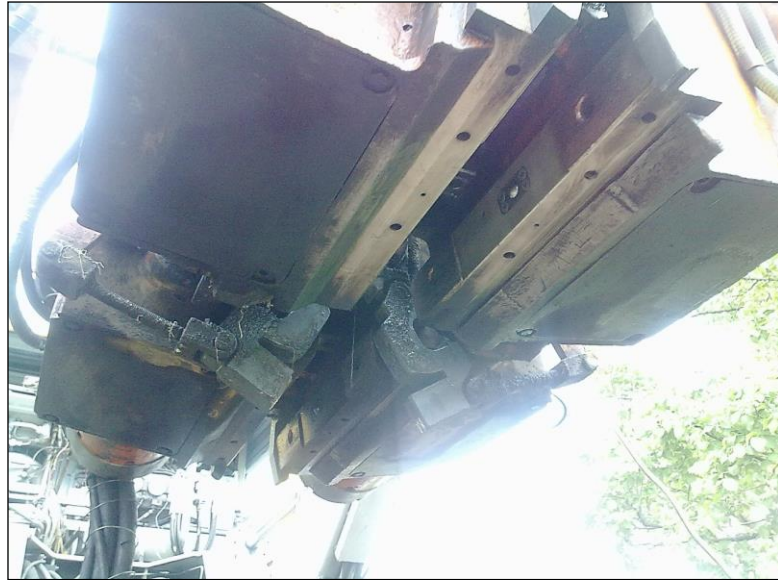
Fotoğraf 2.3. Mobil yakma alın kaynağı makinesinin elektrot düzeni (Bay, 2011)
