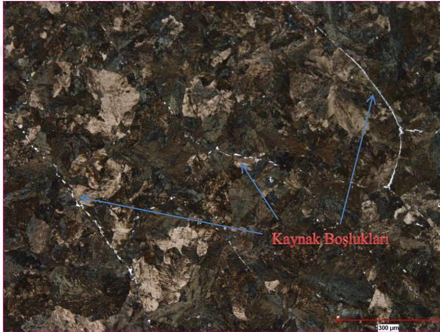
Fotoğraf 4.7. 100X Kaynaklı bölge-ana yapı perlitik-tane sınırlarında ferritler-kaynak boşlukları (Z 1 numunesi)
